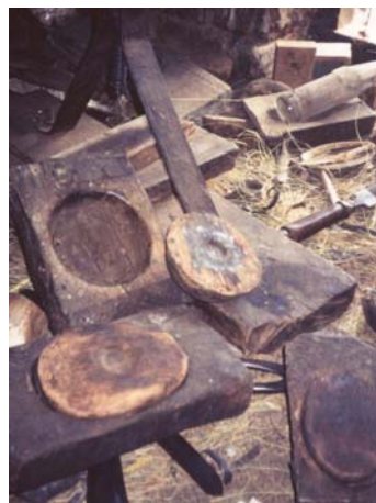
Steg 2) Det upphettade - och därmed formbara hornet pressas platt eller i rundad träform beroende på den tilltänkta slutproduktens utformning. Produkten skärs till.
