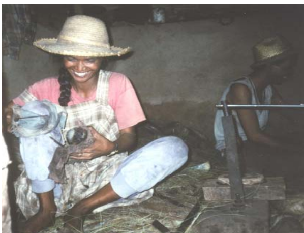
Steg 2) Det upphettade - och därmed formbara hornet pressas platt eller i rundad träform beroende på den tilltänkta slutproduktens utformning. Produkten skärs till.
